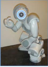
12. Si la position est stable, **enregistrer la dernière position** en appuyant sur les récepteurs tactiles sur la tête.
